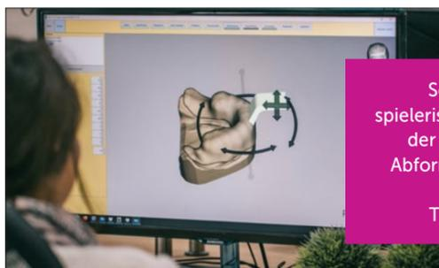
Schnell und fast spielerisch konstruiert der Zahn-techniker Abformlöffel mit der Software BISS Tray-Generator.
